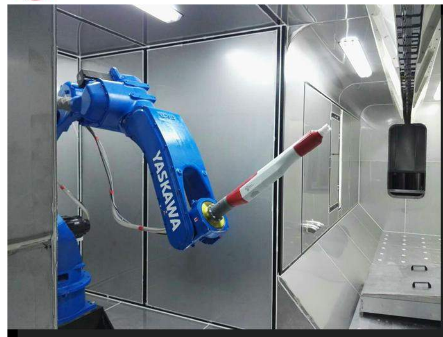
• Automatización mediante robot de una estación de retoque
