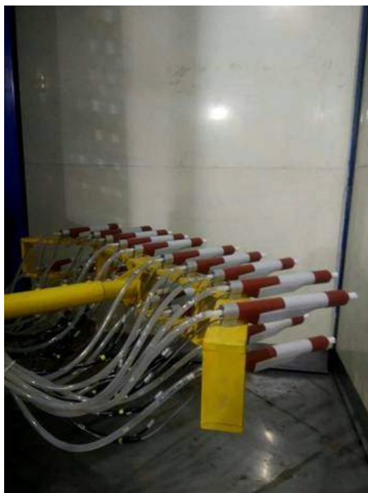
• Pintado de perfiles de aluminio en vertical
