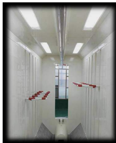
• Pintado de perfiles de aluminio en horizontal
