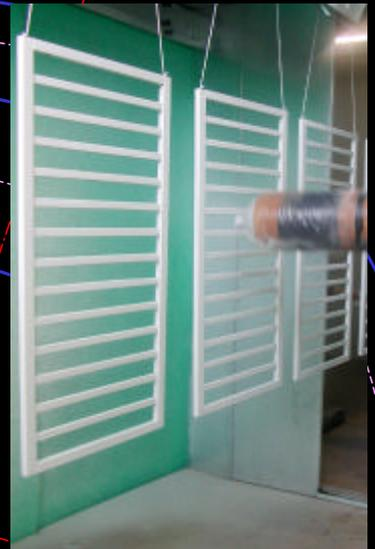
El efecto de la fuerza centrífuga dispersa el producto de modo uniforme hacia la arista de del atomizador, donde la partícula adquiere la carga electrostática.
